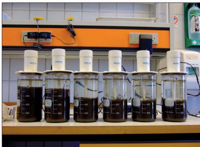
Billedet viser det aktive slamniveau efter tilsætning af forskellige mængder polyamin.
