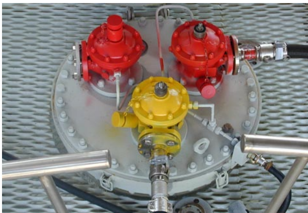
Фото 4. Контейнеры Kemira оснащены специальными клапанами Rhöplix. Для открытия и закрытия клапанов требуется сжатый воздух.
